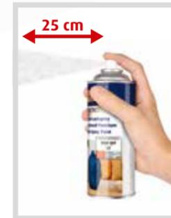
Beim Sprühlackieren Lackspraydose immer senkrecht halten. Durch Probesprühen Farbton prüfen. Der richtige Sprühabstand beträgt 25 cm. Beginnen Sie mit dem Sprayen immer außerhalb des Objektes.
