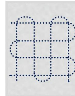
Mehrere dünne Schichten im Kreuzgang aufsprühen, erst vertikal dann horizontal. Warten Sie dazwischen 2-3 Minuten.
